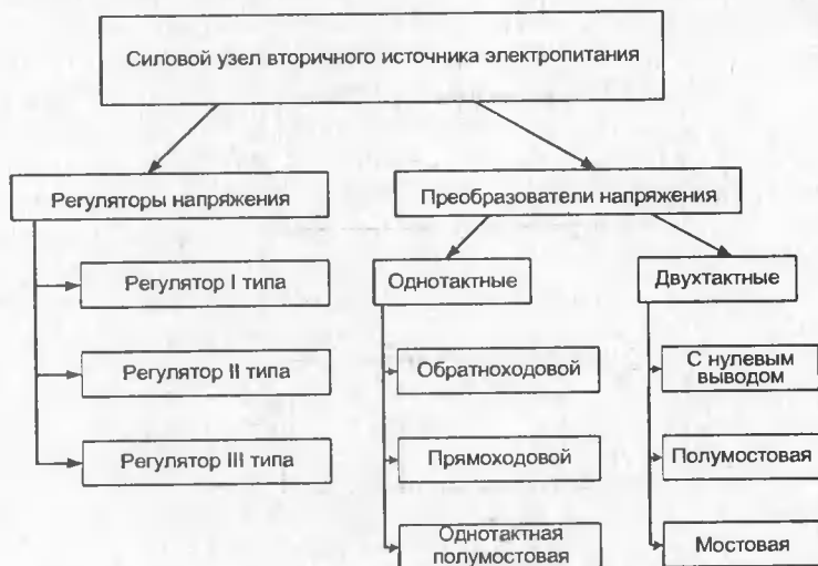
Рис. 4.2. Классификация силовых узлов
