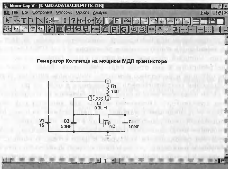
Рис. 11.14. Схема генератора Колпитца на мощном полевом транзисторе
