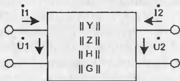
Рис. 9.2. Обобщенная схема усилителя мощности на активном четырехполюснике
