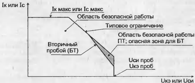
Рис. 2.31. Области безопасной работы мощного полевого и биполярного транзисторов
