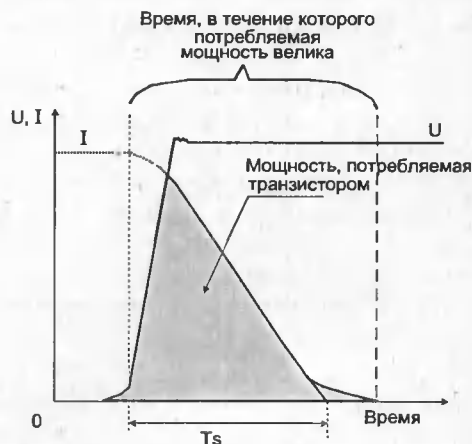
Рис. 2.33. Мощность, потребляемая МДП-транзистором при выключении
